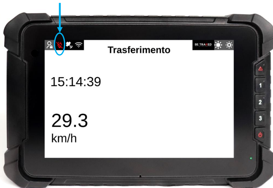
Figura 2 - Spia alimentazione di colore rosso: dispositivo non alimentato
